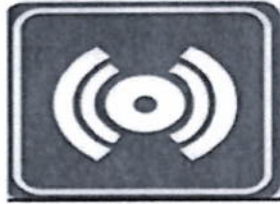
Ubicación de un dispositivo de activación de alamar
